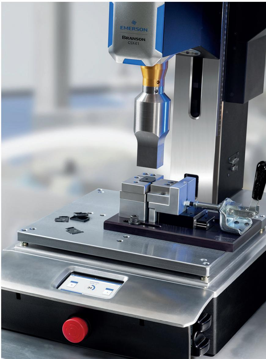
Ultraschall- und Laserschweißgeräte verbinden unter anderem Infusionsbeutel ungiftig und energieeffizient. Bei Emerson werden sie unter dem Produktnamen Branson angeboten. © Emerson
